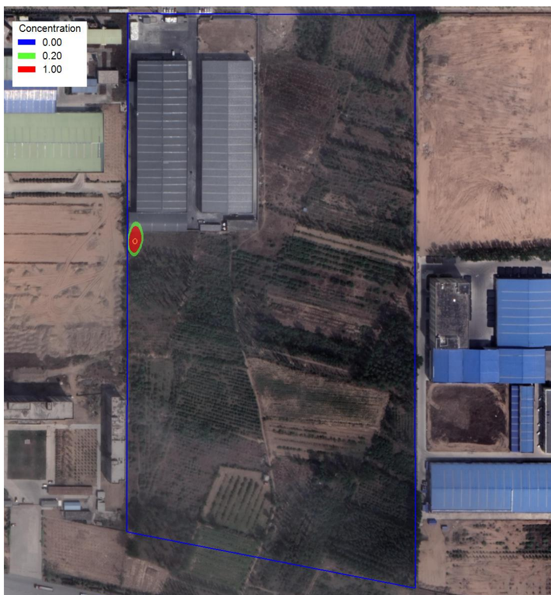
图 4.3-29 氟化物泄露 30d 时的污染晕图
