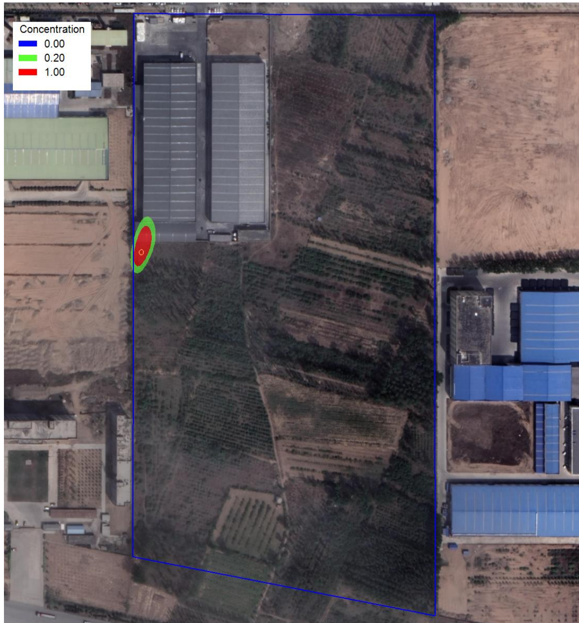
图 4.3-30 氟化物泄露 100d 时的污染晕图
